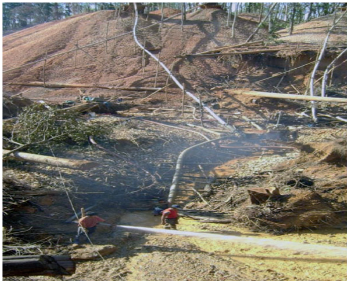
Foto 17: Método de chupadera en el Río Puquiri, Delta 1, Madre de Dios (archivo fotográfico PDMA-CooperAcción). Método de chute-cargador frontal
