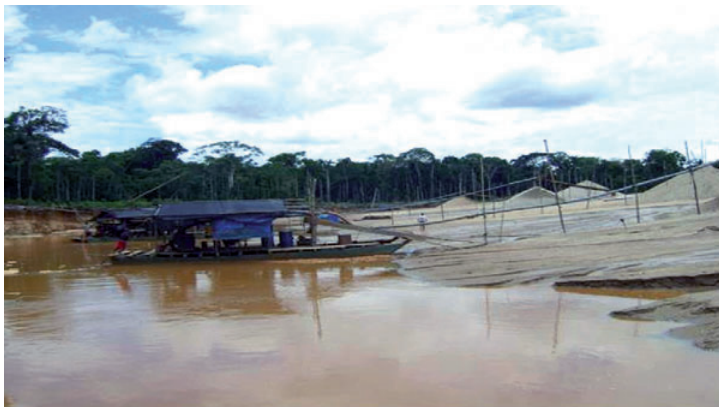
Foto 11: Método de la balsa en Malinowski, Madre de Dios. Esta variación es llamada “balsa castillo” y se realiza sobre las playas de los ríos (archivo fotográfico PDMA-CooperAcción).
