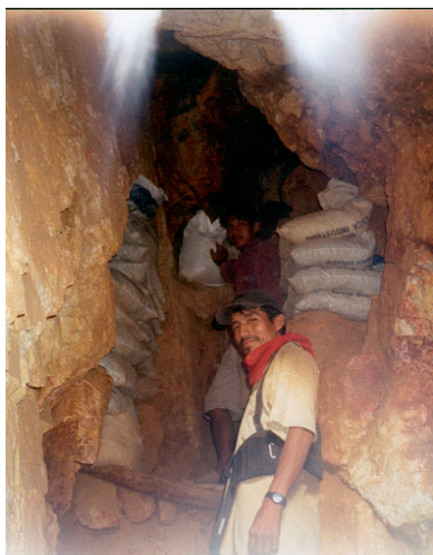
Foto 4: Interior de la mina de Otonca en Ayacucho. Galerías estrechas trabajadas por métodos de socavones (archivo fotográfico PDMA-CooperAcción).
