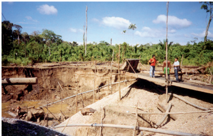
Foto 15: Método de chupadera en el Río Madre de Dios. Se aprecia un grupo de mineros realizando la explotación por este método (archivo fotográfico PDMA-CooperAcción).
