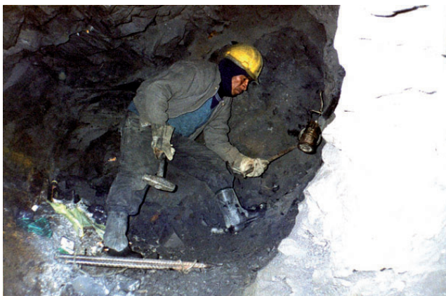
Foto 6: Socavones de la mina La Rinconada en Puno. Minero explotando mineral con método de cámaras y pilares (archivo fotográfico PDMA-CooperAcción).
