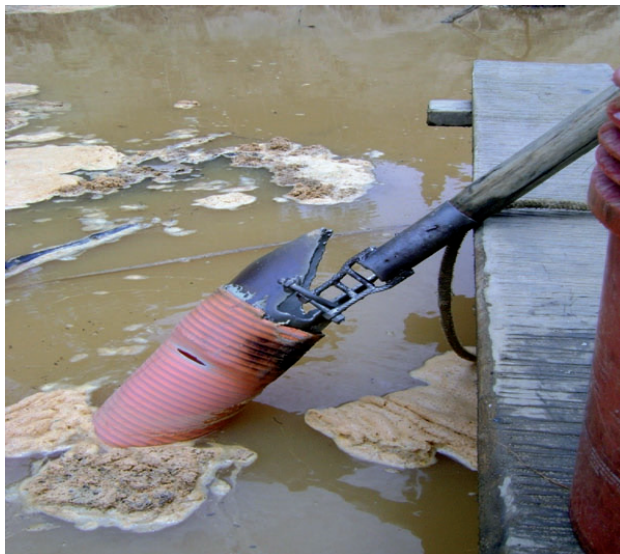
Foto 12: Método de la Balsa en Malinowski, Madre de Dios. Se aprecia el “gringo” formado por la manguera de succión con una armazón de metal en forma de corona (archivo fotográfico PDMA-CooperAcción).
