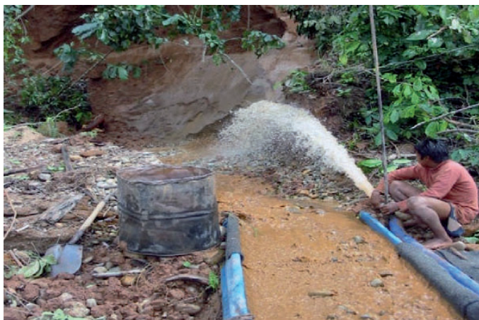
Foto 13: Método de Arrastre en Malinowski, Madre de Dios. Un minero opera una manguera a presión (archivo fotográfico PDMA-CooperAcción).
